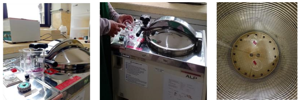
Gambar 1. Melakukan Bioindikator Sterikon Plus di Alat Autoclave
