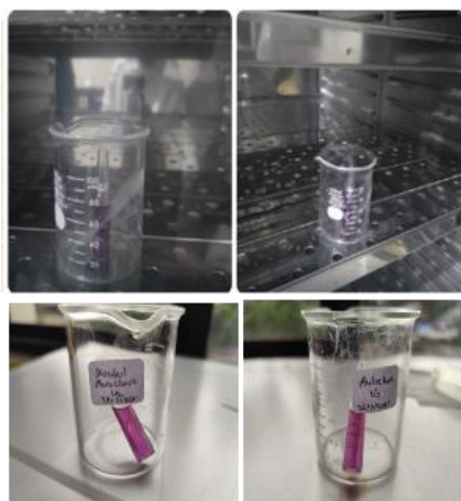
Gambar 2. Warna Bioindikator Sterikon plus di alat utoclave
