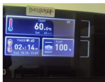
Gambar 5. Inkubator dengan temperatur 60°C selama 48 Jam
