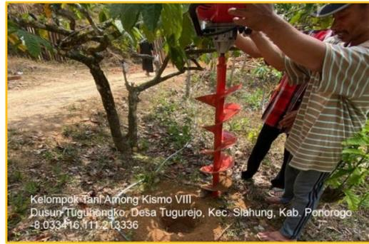
Gambar 32. Bantuan mesin lubang biopori dan pembuatan lubang biopori
